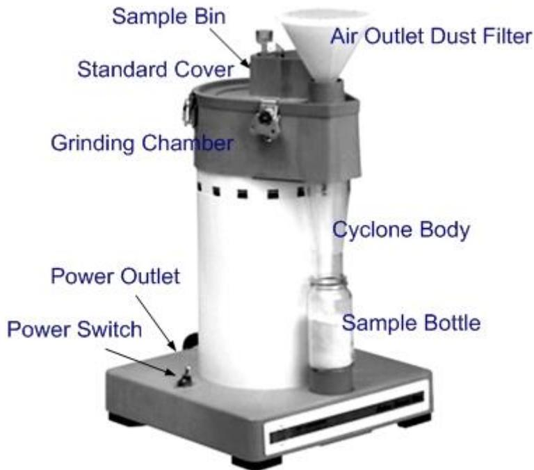
Figura 2. Cámara de Molienda del Molino Ciclónico
